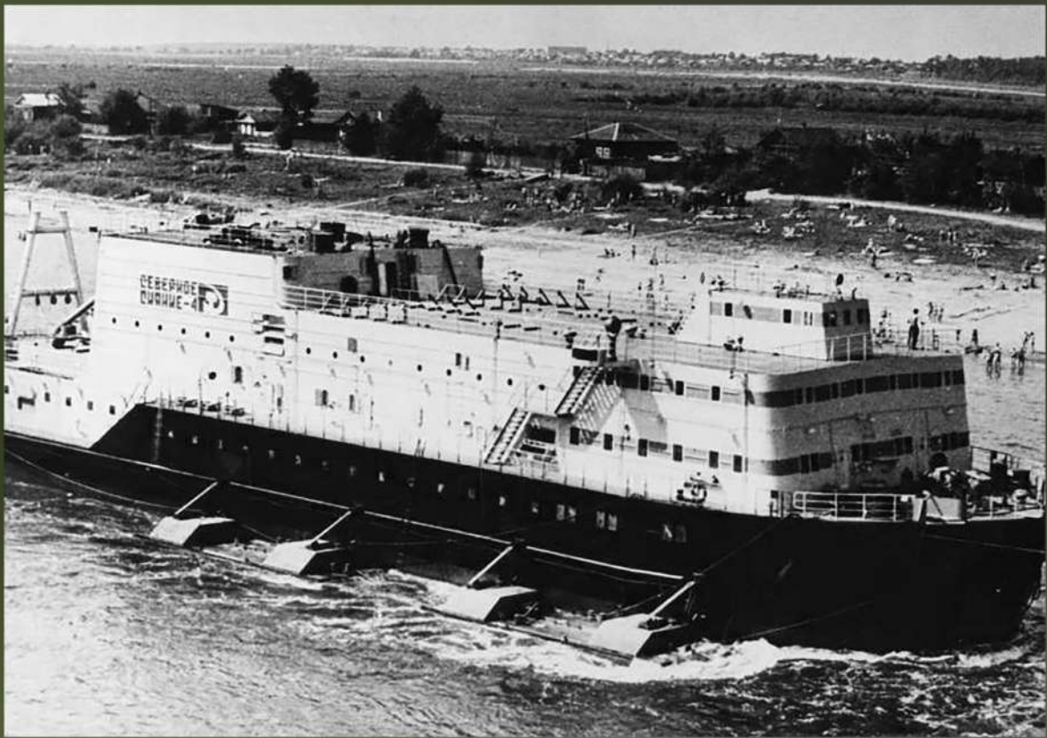
Плавучая электростанция «Северное сияние-4». Произведена на Тюменском судостроительном заводе. 1975 г. Автор не установлен Музейный комплекс им. И.Я. Словцова ГАУК ТО «ТМПО»
