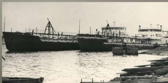
Танкер проекта 1754 А. Произведён на Тюменском судостроительном заводе. 1980-е гг. Автор не установлен Музейный комплекс им. И.Я. Словцова ГАУК ТО «ТМЮ»
